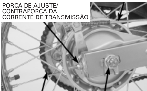
CORRENTE DE TRANSMISSÃO PORCA DO EIXO TRASEIRO PARAFUSOS DA PLACA DE FIXAÇÃO
