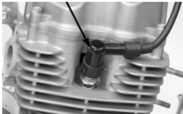
SUPRESSOR DE RUÍDO DA VELA DE IGNIÇÃO
